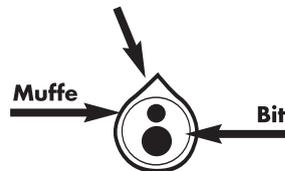
4. Ziehen Sie die Patrone fest, indem Sie die Patronenmutter gegen den Uhrzeigersinn drehen. Das Gerät ist nun betriebsbereit. Um eine Wire-Wrap-Verbindung herzustellen, befolgen Sie die Anleitungen und hilfreichen Tips auf den folgenden Seiten.
