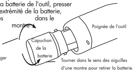
Tourner dans le sens des aiguilles d'une montre pour retirer la batterie.
