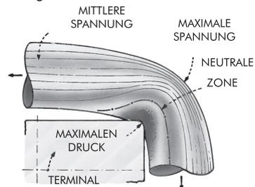
Der Draht wird während des Verfahrens einer enormen Spannung und hohen Druckkräften ausgesetzt, normalerweise 100.000 PSI (6.895 bar) an der Anschlußkante.
