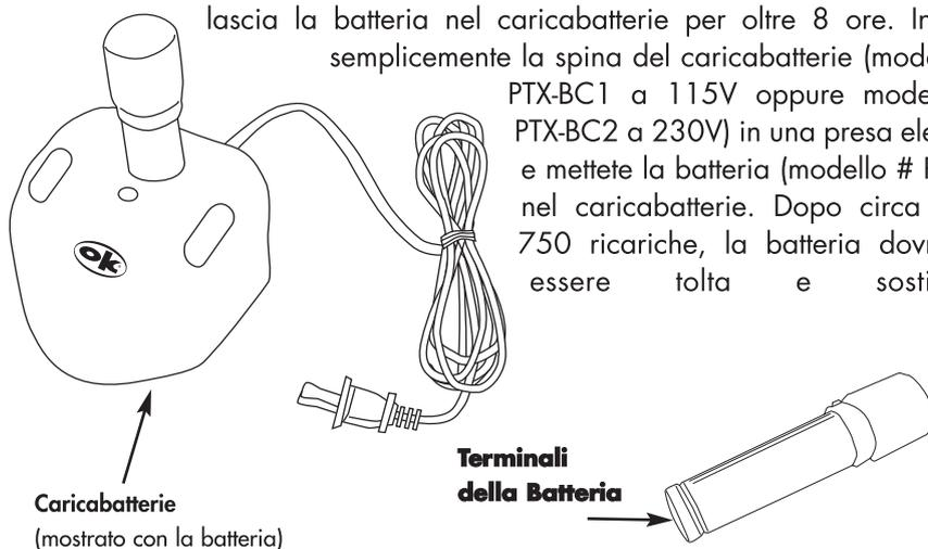
Quando la batteria non è montata nell'attrezzo o nel caricabatterie, è importante che i terminali non siano messi in corto circuito da parte di qualsiasi metallo o di altri oggetti conduttivi. La batteria andrebbe altrimenti in corto circuito, rischiando di prendere fuoco, bruciare o danneggiarsi. La batteria PTX-B al NiMH è ecologica, e può essere smaltita come normale rifiuto.
