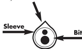
4. Serrer la bague en tournant l'écrou tournant dans le sens inverse des aiguilles d'une montre. L'outil est maintenant prêt à être utilisé. Pour faire une connexion par fil enroulé, suivre les instructions et lire les astuces utiles sur les pages qui suivent.
