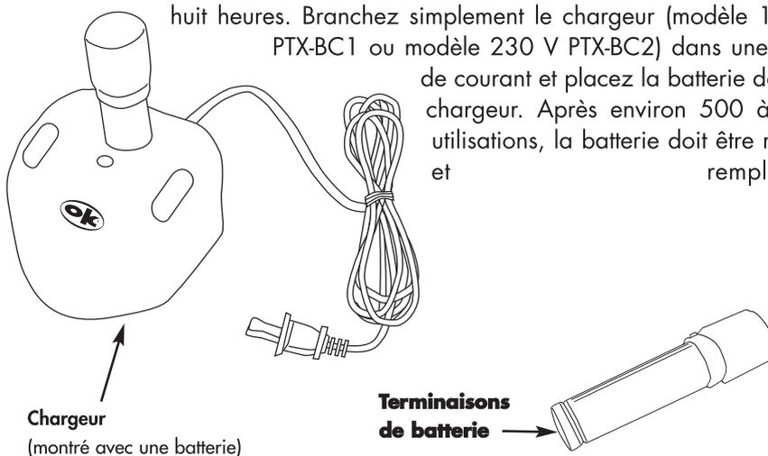
Quand la batterie n'est pas montée dans l'outil ou le chargeur, il est important de s'assurer que ses terminaisons ne sont pas mises en court circuit par un objet métallique ou conducteur. Un court circuit de la batterie peut provoquer un incendie, des brûlures ou endommager la batterie. La batterie PTX-B est un modèle NiMH qui peut être jetée et incinérée sans effet nocif pour l'environnement.
